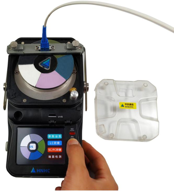
4、研磨完成，取下制作完成的光纤连接器，插入端面检测口，判断是否合格，如显示屏上端面成像光洁，则光纤连接器制作完成
