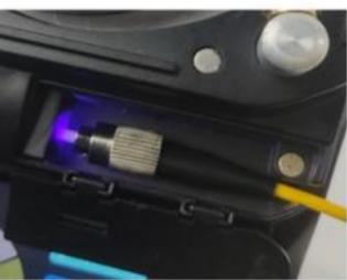
⑨: 安装尾套, 机器内部固化
