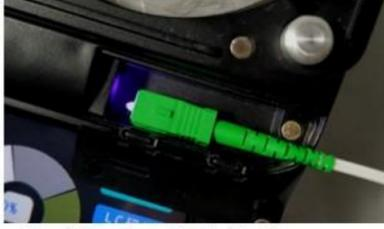
⑧: 安装尾套, 机器内部固化
