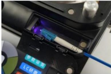
⑧: 安装尾套, 机器内部固化
