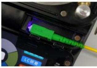
⑨: 安装尾套, 机器内部固化
