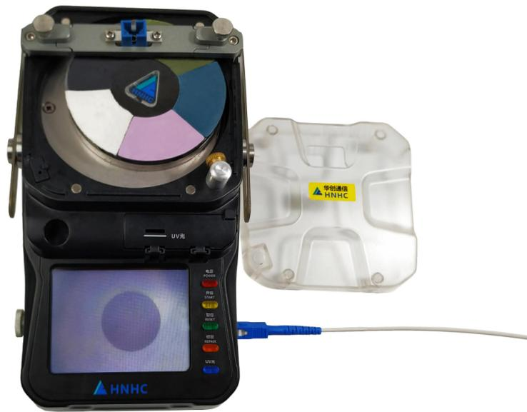
5、研磨完成后擦拭砂纸，确保下次成端质量
