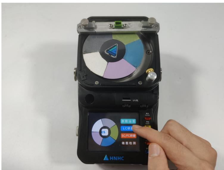
3、更换砂纸。打开夹具压块，取下夹具，撕掉旧砂纸，清洁胶垫，取出新砂纸，撕掉砂纸背胶，将砂纸镂空三角处对准研磨盘上的三角标识，轻轻按压，完成更换。如图所示：
